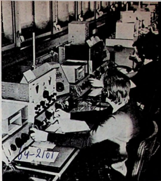
DE RADIOTELEFONIE-AFDELING, midden-golf ontvang- en bedientafels
